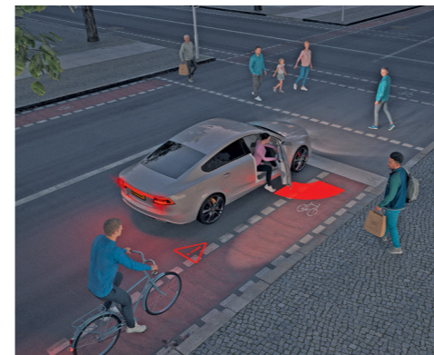
Laserstrahl-Scans ermöglichen Anwendungen wie die Projektion eines seitlichen Lichtteppichs. © Continental
