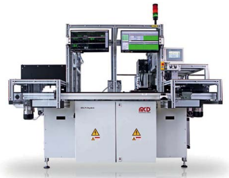
Bild 2: Inline-Testanlage für LKW-Antennen mit HF-Messung, Laserbeschriftung und Kameraprüfung (Bild: MCD Elektronik)
