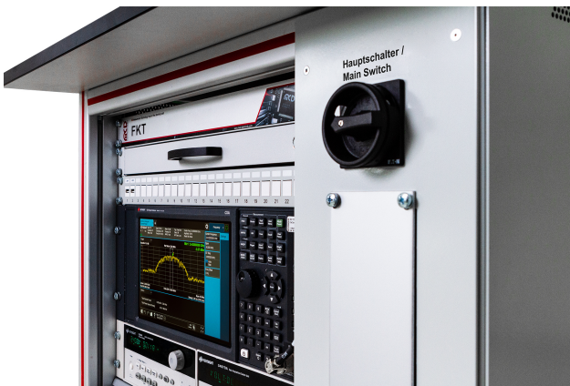
Bild 1: Prüfung und Feinabgleich von WLAN- und ZigBee-Signalen im FKT mit Spektrum-Analysator für höchste Signalqualität.
