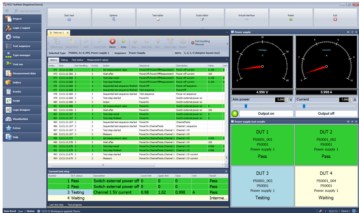
Abb. 4: Hauptansicht des MCD TestMate mit integrierten Toolmonitoren und DUT-Handling
