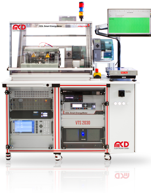
Prüfung eines Smart Energy Meters auf Funktion und Eichrechtskonformität in MCD EOL-Systemen
