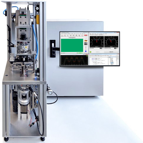
End-of-Line-Test eines Feintechnik-Antriebsrads – Qualität direkt an der Fertigungslinie
