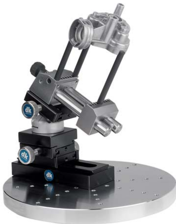
Die CT-Fixierlösung von DK Fixiersysteme mit Linearverstellung, 3D-Neigekopf, Präzisionsschraubstock und röntgentransparenten Spannzwichenelementen.
